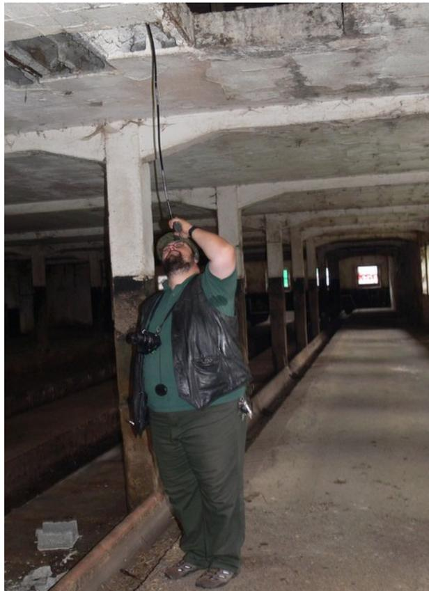
**Abb. 3.1: Untersuchung von Hohlräumen mit dem Endoskop im Bullenmaststall**
