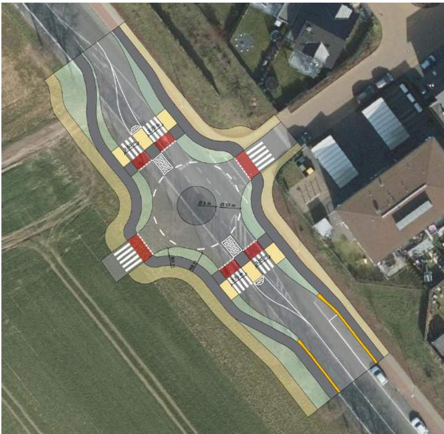
Abbildung 5-1: Entwurf eines Mini-Kreisverkehrs für die nördliche Anbindung des Malerviertels III
