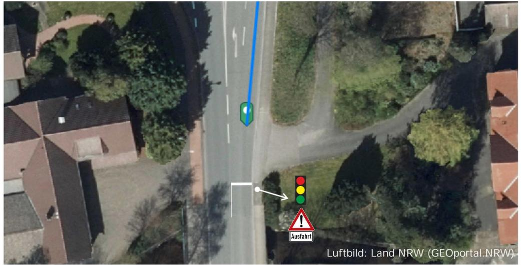
Abb. 16 Anordnung einer Haltelinie mit Signalanlage und Hinweisschild
