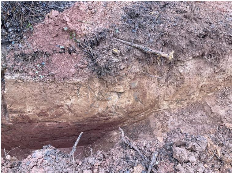
**Bild 2: Schurf 2 zur Ausführung der Versickerungsversuche**
