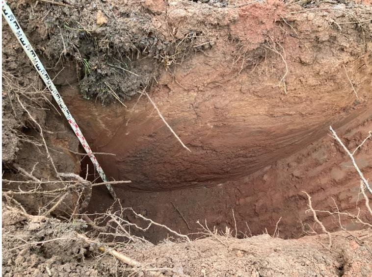
**Bild 1: Schurf 1 zur Profilaufnahme**
