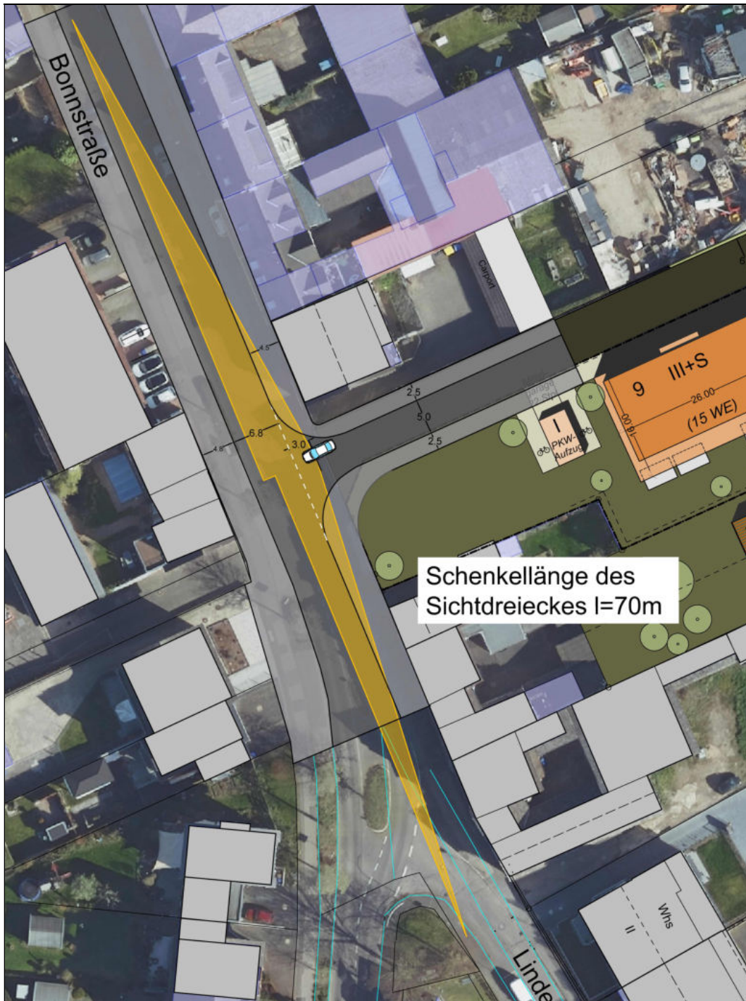
Bild 16: Lageplan Einmündung Planstraße / Bonnstraße mit Sichtdreiecken
