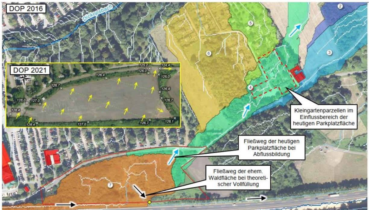
Abbildung 1: Fließwege mit Fließpfeilen und Einzugsgebieten im Bereich der ehemaligen Waldfläche mit digitalen Orthophotos (DOP) im Hintergrund (Q: Fließweganalyse, Ingenieurbüro für Bauwesen Schmidt, 2022, S. 21)
