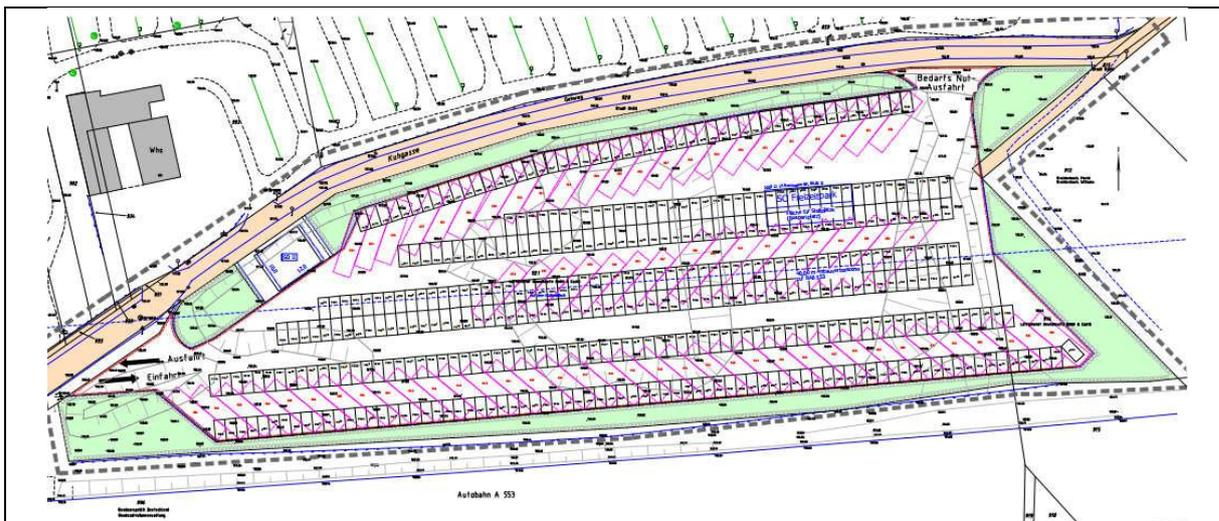
**Abbildung 10: Entwurfszeichnung des Busparkplatzes für Busse in magenta und PKW in schwarz (Schmidt- Löffelhardt GmbH & Co. KG, 2015)**
