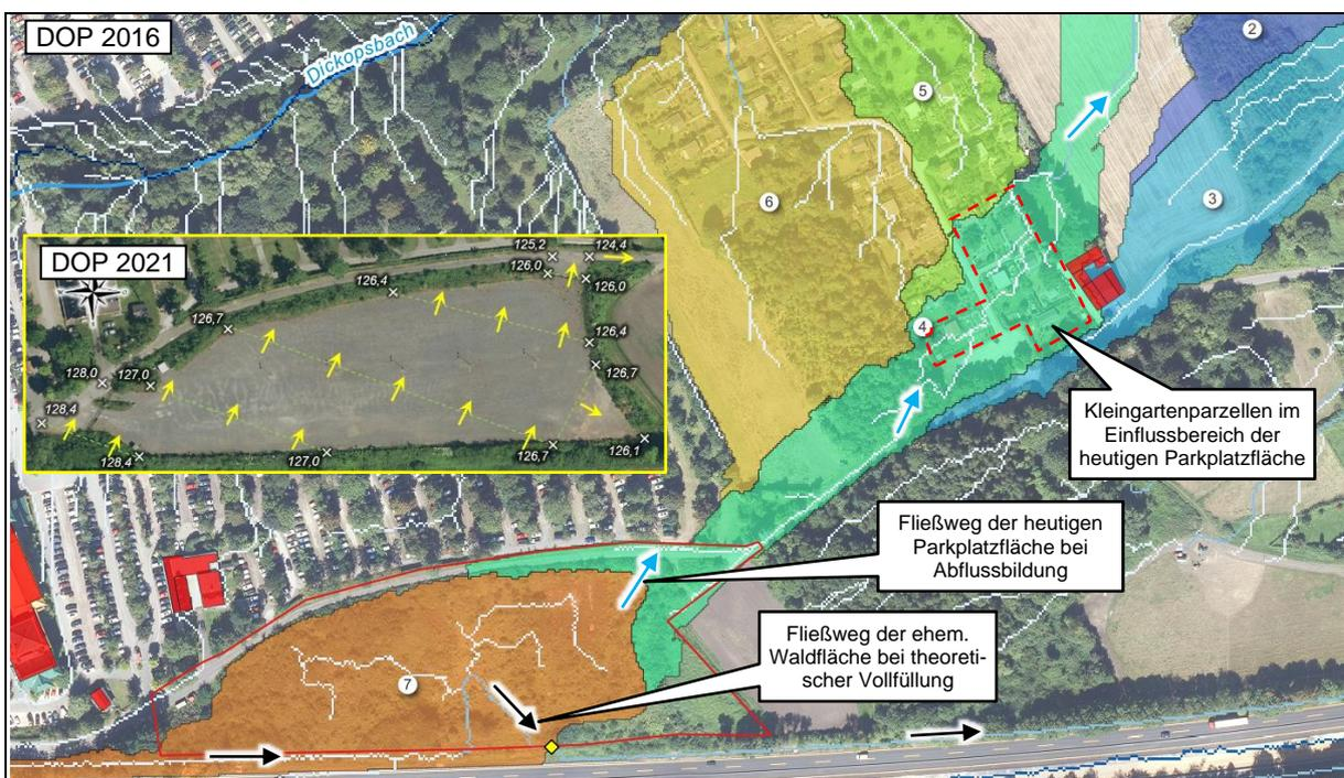
**Abbildung 19: Fließwege mit Fließpfeilen und Einzugsgebieten im Bereich der ehemaligen Waldfläche mit digitalen Orthophotos (DOP) im Hintergrund**
