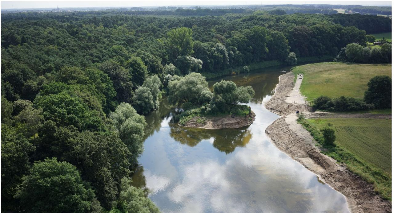
Abb. 3: Aufweitung der Lippe im Bauabschnitt 1 (BA1) (© Lippeverband)
