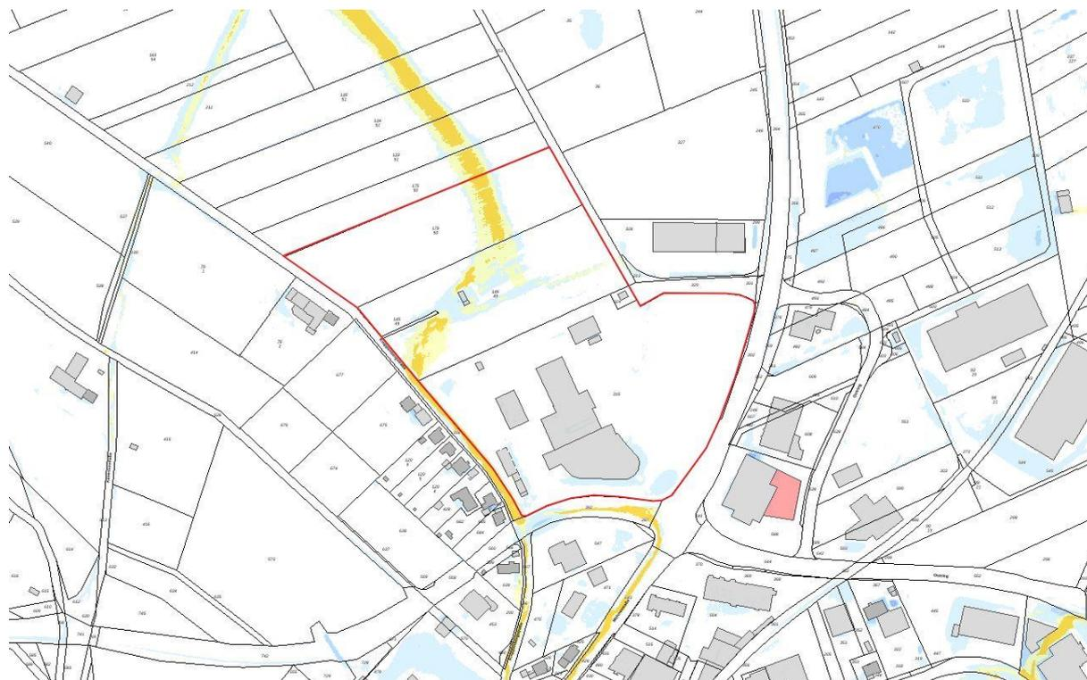
Starkregengefahrenhinweiskarte mit Wasserhöhen (blau) und Fließgeschwindigkeiten (gelb) im extremen Ereignis
