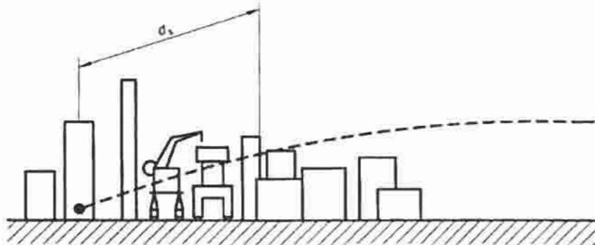
Bild A.2: Das Dämpfungsmaß  $A_{\text{site}}$  wächst proportional zur Länge des durch die Installationen in Industrieanlagen verlaufenden Weges  $d_1$ .
