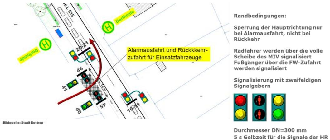
Abbildung 33: Mögliche Signalisierung der Feuerwehrausfahrt
