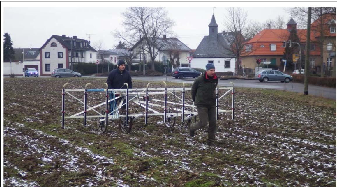
Abbildung 2: Das magnetische Messsystem LEA MAX in Bornheim-Sechtem
