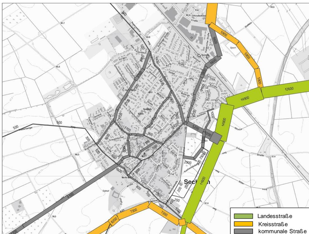
**Bild 9:** Prognose-Mit-Fall (PM) 2030 [DTV Kfz/24h] im Untersuchungsraum
