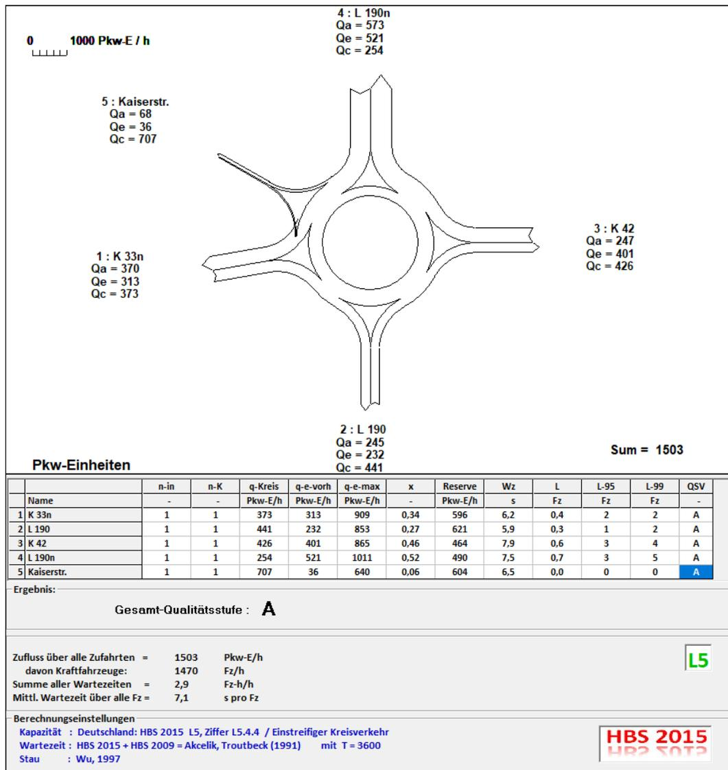
**Bild 12:** Ergebnisse der Leistungsfähigkeitsprüfung nach HBS für den Knoten L 190n/K 33n/K 42
