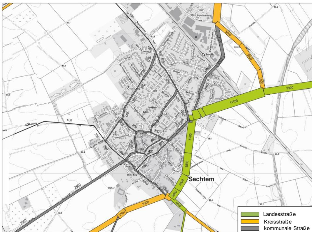
**Bild 5:** Analyse-Null-Fall 2017 [ DTV Kfz/24h] im Untersuchungsraum
