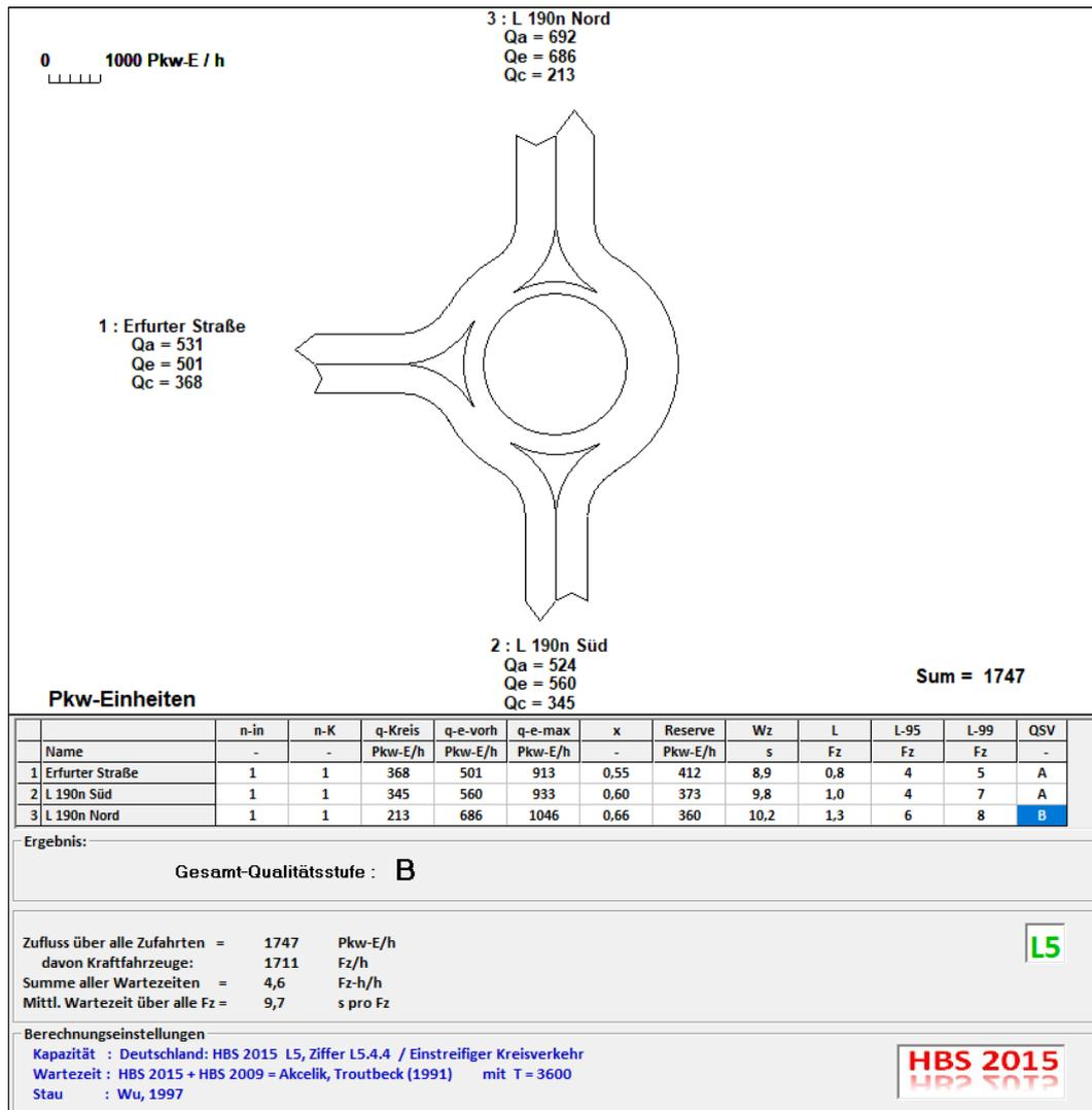
**Bild 11:** Ergebnisse der Leistungsfähigkeitsprüfung nach HBS für den Knoten L 190n/Erfurter Straße
