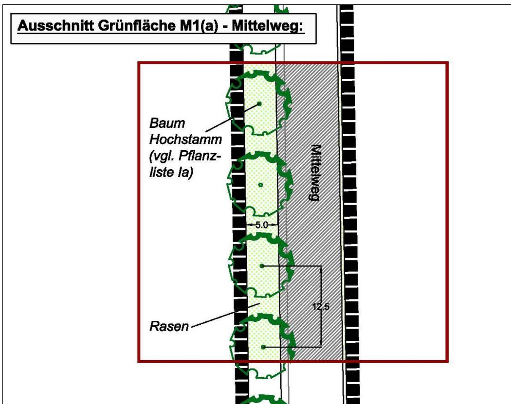
Abbildung 2: Pflanzschema Maßnahmenfläche 1, Schema 1a
