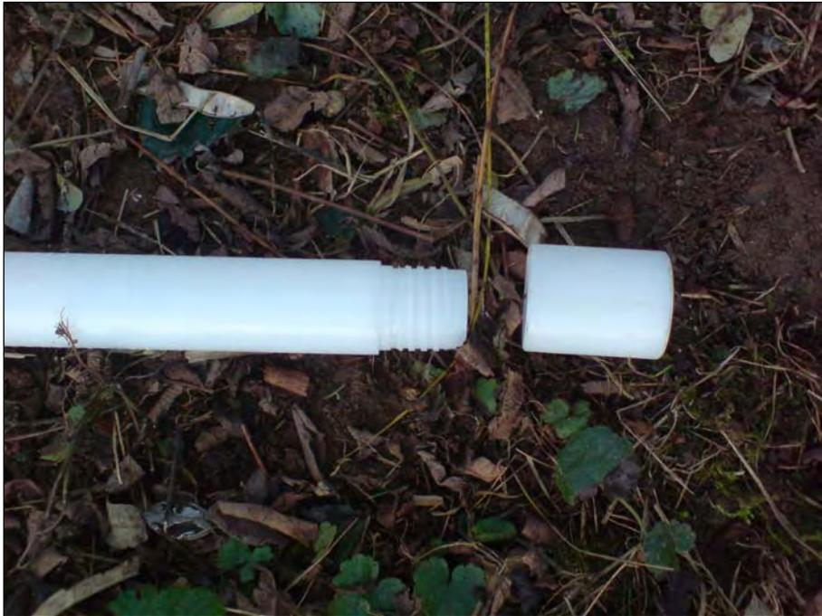
Bild 7: Ausbaumaterial: PE-Rohr mit Bodenkappe
