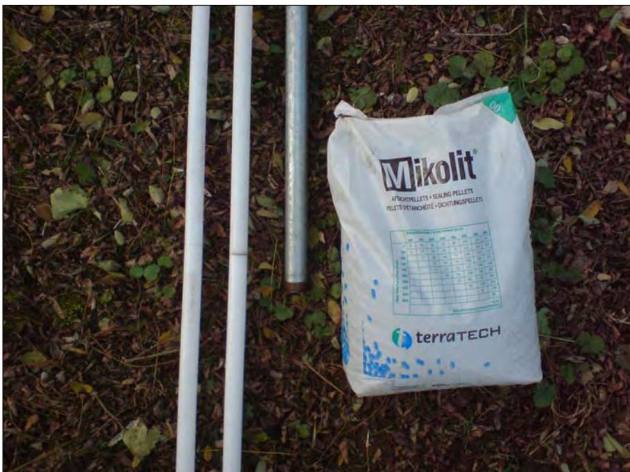
Bild 8: Ausbaumaterial: PE-Rohr, Stahlaufsatzrohr, Quellton
