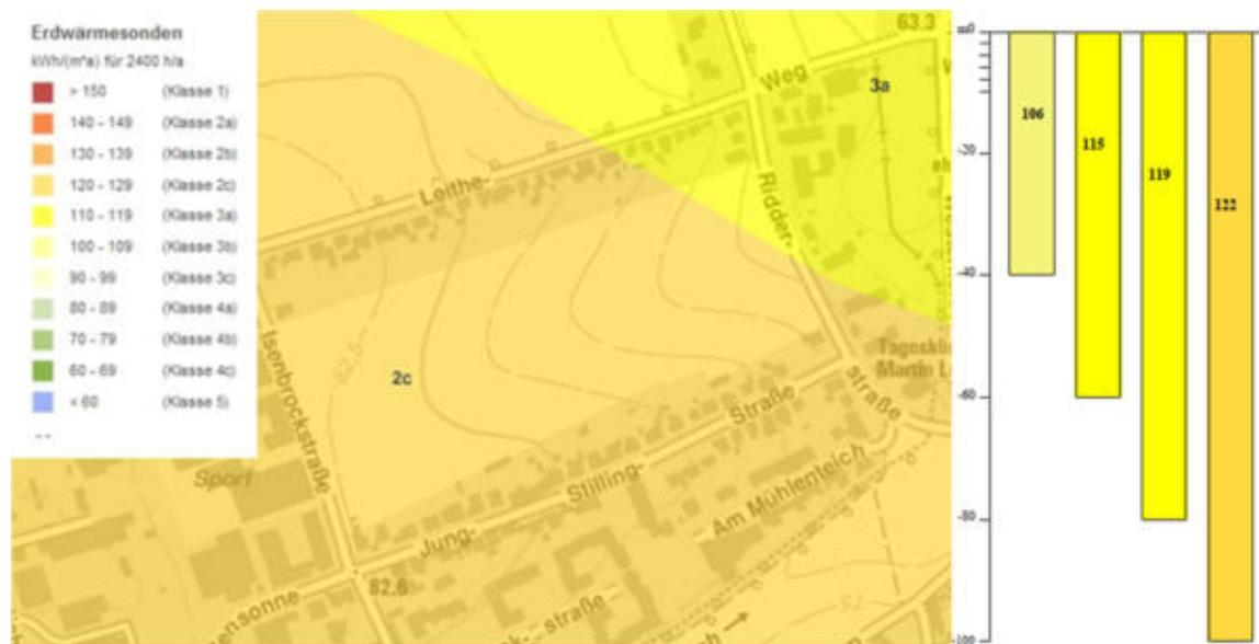
Abbildung 7 Spezifische Ergiebigkeit Erdsonden (Quelle: Geologischer Dienst NRW, 2022)
