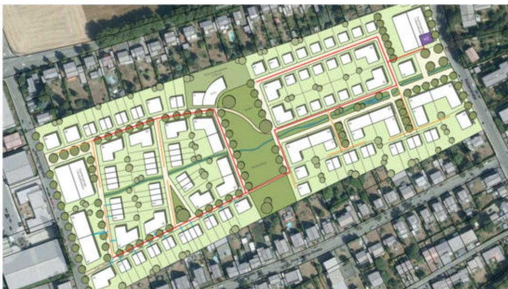
Abbildung 17 Wärmenetz mit Heizzentrale im Osten des Quartiers
