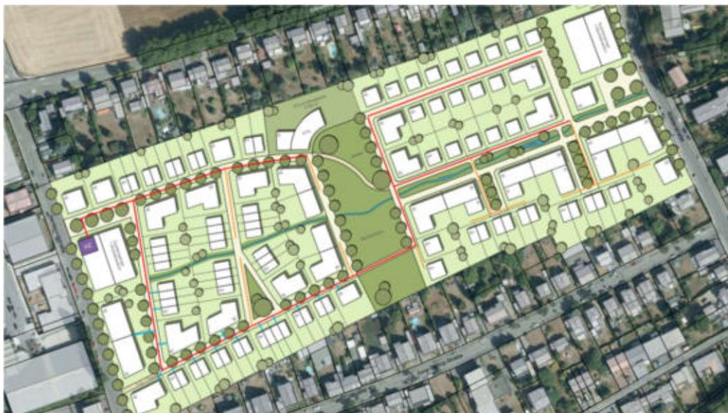
Abbildung 16 Wärmenetz mit Heizzentrale im Westen des Quartiers
