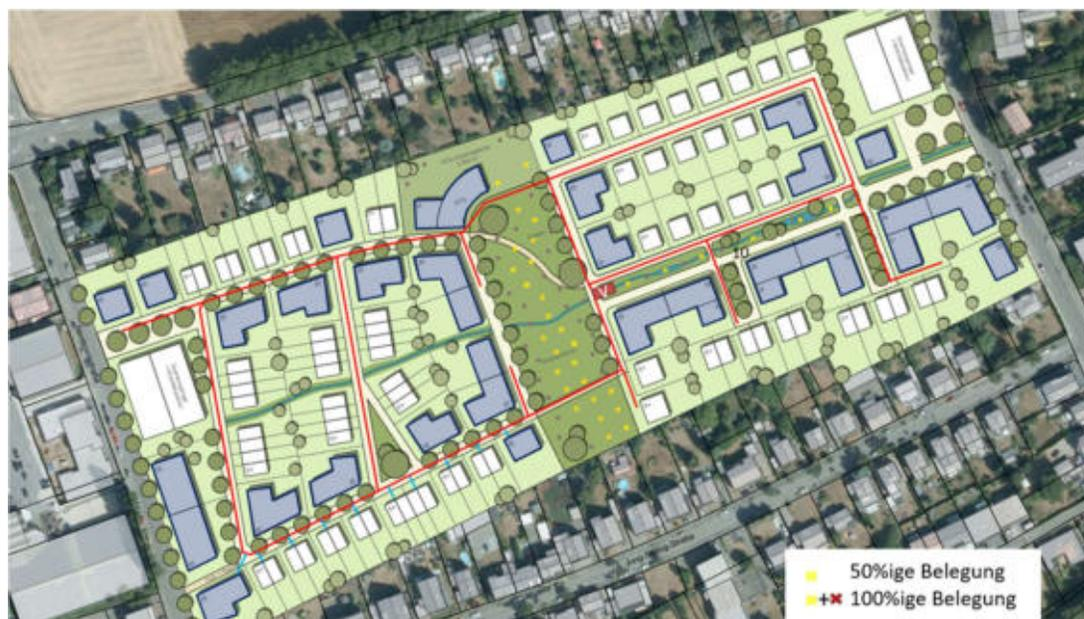
Abbildung 9 Verteilung der 33 Erdsonden (50 %) + zu versorgende Gebäude (MFH+KiTa)
