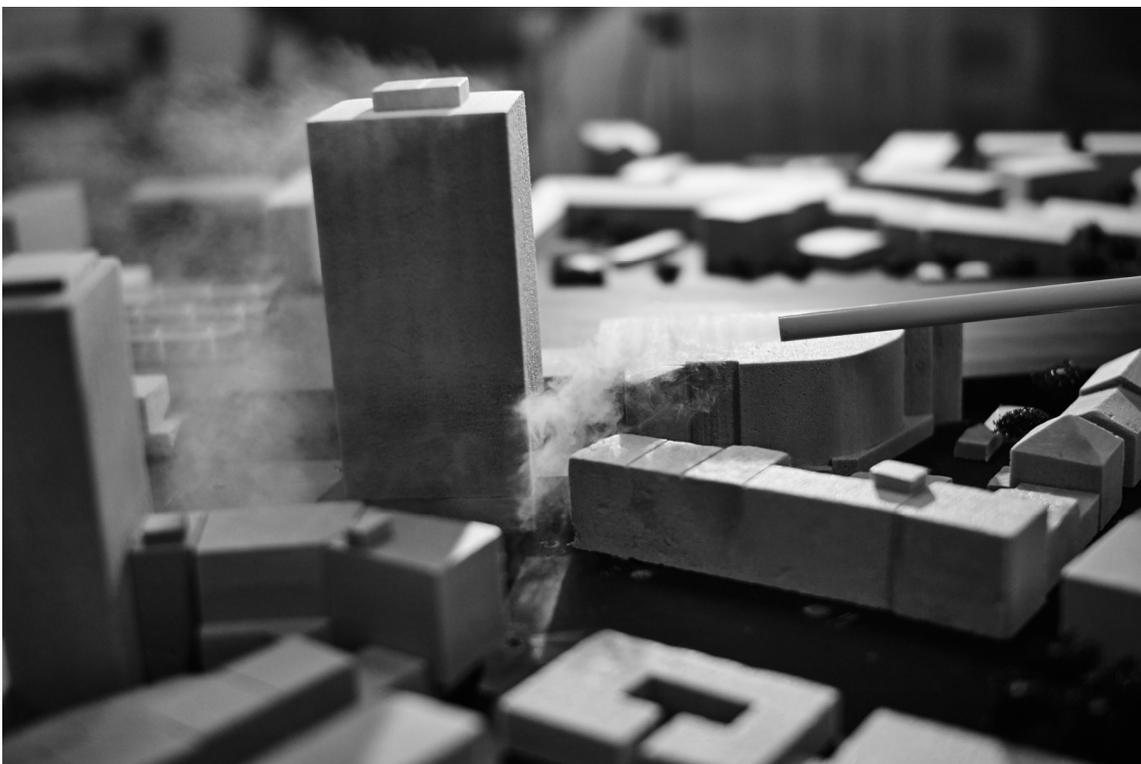
**Bild 16:** Sichtbarmachung der Abwärtsströmung an der Hauswand des Hochhauses bei SSW-Wind
