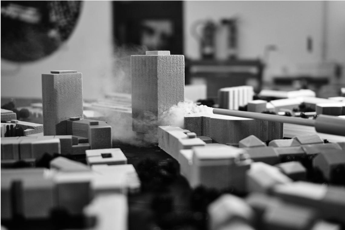
**Bild 15:** Sichtbarmachung der Abwärtsströmung an der Hauswand des Hochhauses bei SSW-Wind
