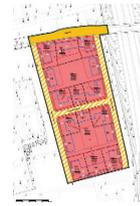
Da die geplante Bebauung innerhalb des Plangebietes nicht gesichert ist und damit auch nicht die Abschirmwirkung durch die geplanten Baukörper, wurde sie bei der Berechnung der Lärmbelastung im Plangebiet nicht berücksichtigt. Hierdurch ergeben sich Beurteilungspegel auf der „sicheren Seite“, da die Abschirmwirkung der Bebauung nicht berücksichtigt wird und somit die Lärmbelastung überschätzt wird.
