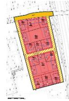
Die Lärmkarten zeigen, dass ohne Lärmschutzmaßnahmen der schalltechnische Orientierungswert von 55 dB(A) am Tag und 45 dB(A) in der Nacht für eine Wohnnutzung (WA) im Plangebiet überall überschritten wird.
