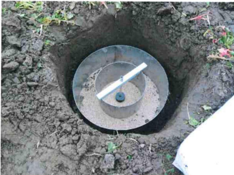
Foto 2: Doppelring-Infiltrometer im Schurfloch, der anstehende Boden ist mit Filterkies bedeckt.
