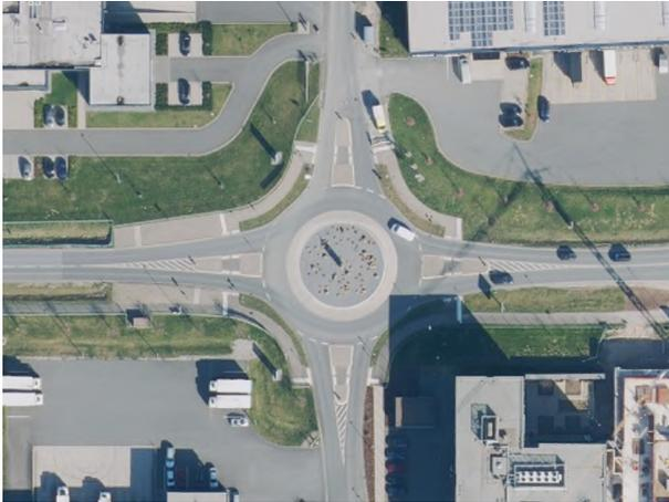
Bild 2 – Geometrie des Kreisverkehrs
