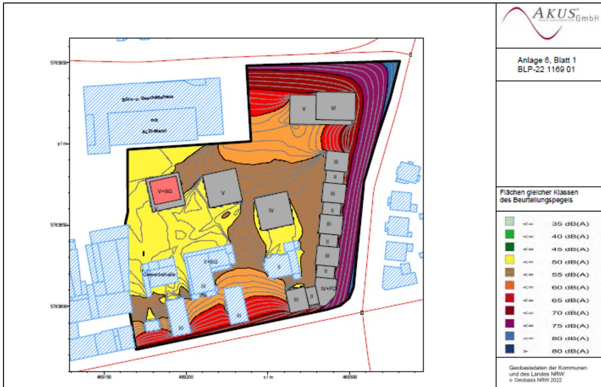
**Schalltechnische Berechnungen: Geräuschemissionen Verkehr (Straße und Schiene) mit allen geplanten Gebäuden tags, EG**
