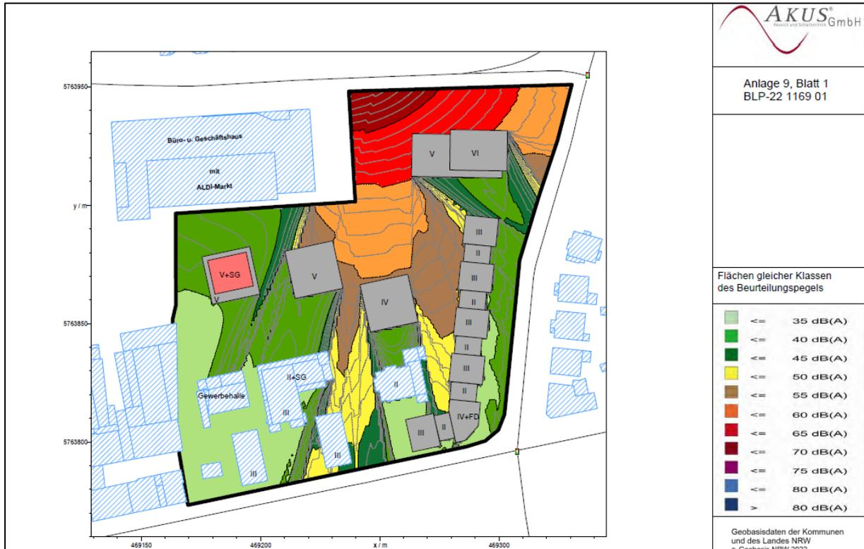
**Schalltechnische Berechnungen: Geräuschimmissionen Betrieb Seidensticker Halle mit allen geplanten Gebäuden nachts, EG**
