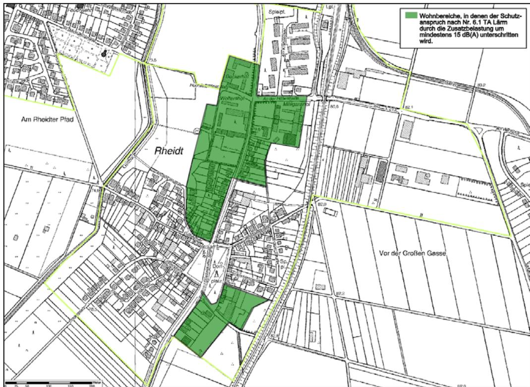
Abbildung 4. Wohnbereiche in Rheidt, in denen der Geräuschbeitrag aus dem Musterkraftwerk irrelevant ist.
