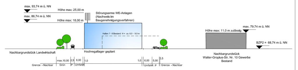
Beispiel: Schemaschnitt A - A, M 1 : 500
