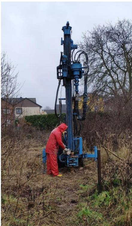
Abb.1: Sickerversuch „Am Gillbach“
