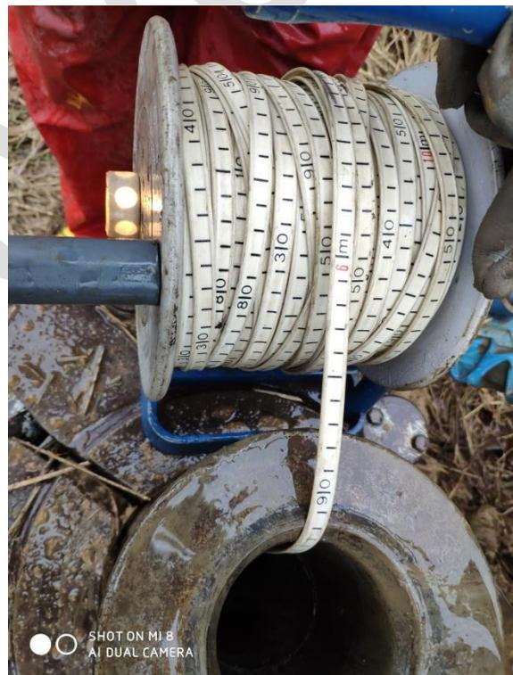
Abb.2: Druckwasserspiegel 5,20 m unter derzeitiger GOK
