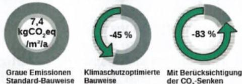
Durch klimaschützendes Bauen – im Beispiel Holzrahmenbau – lassen sich die grauen Emissionen um 45 % vermindern. Wird berücksichtigt, dass im verbauten Holz CO<sub>2</sub> eingelagert wird, dann liegt die Minderung sogar bei 83 %. Der Rohstoffverbrauch lässt sich um 50 % mindern.
