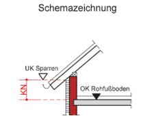
Einzelgauben (max. 1,40 m breit) bzw. Doppelgauben (max. 2,80 m breit) und Zwerchgiebel (max. 1/3 der Dachlänge) zulässig. Die Summe aller Dachaufbauten und Zwerchgiebel darf nicht mehr als 1/3 der maßgeblichen Dachlänge betragen.
