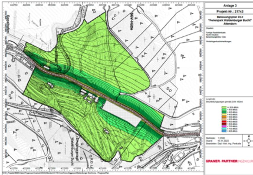
Abb. 9: Beurteilungspegel Nacht-Situation, Berechnungshöhe 5,00 , Anlage 3. (Quelle: Ingenieurbüro 'Graner + Partner Ingenieure GmbH', Schalltechnisches Prognosegutachten)
