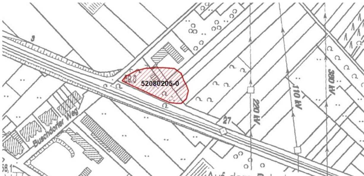
Es handelt sich um eine alte Kiesgrube, welche mit Erdaushub und Anteilen von Bauschutt und Bahnschotter verfüllt worden ist. Im Rahmen von chemisch-analytischen Untersuchungen, welche im Jahre 2009 im Bereich der Altablagerung durchgeführt wurden, konnten keine relevanten Verunreinigungen festgestellt werden. Der Altstandort hat somit den Flächenstatus *Kein Verdacht / keine Gefahr bei derzeitiger oder planungsrechtlich*
