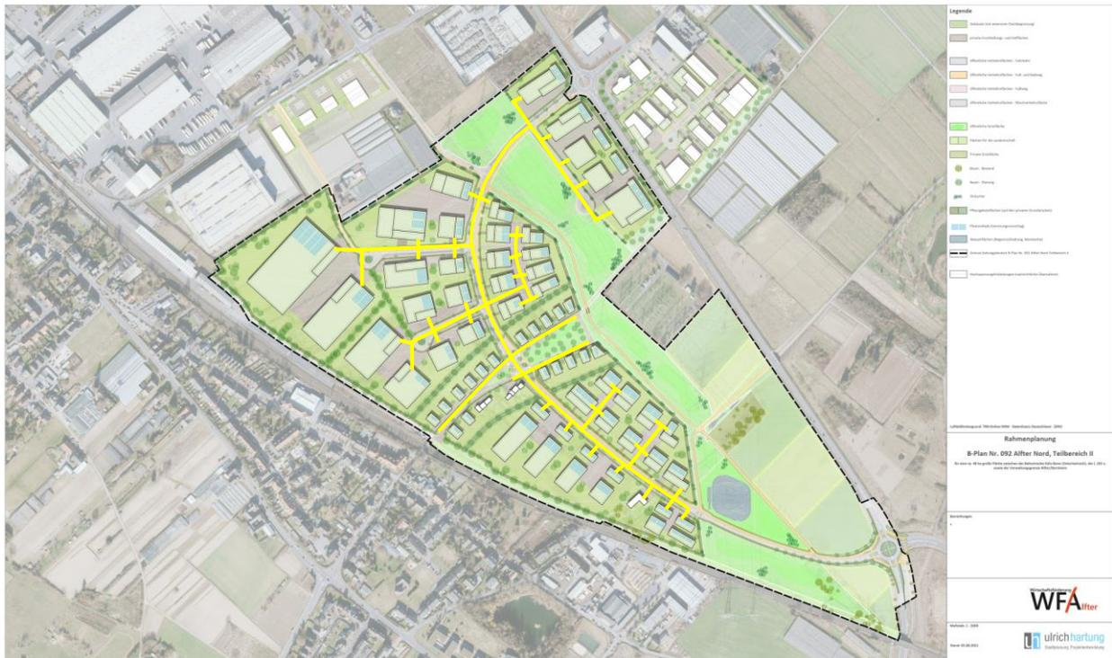
Abbildung 2 Mögliche Trassierung eines Nahwärmenetzes
