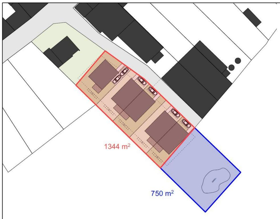
Abb. 15: Zu bebauende Fläche und Fläche für Versickerung und Ausgleich
