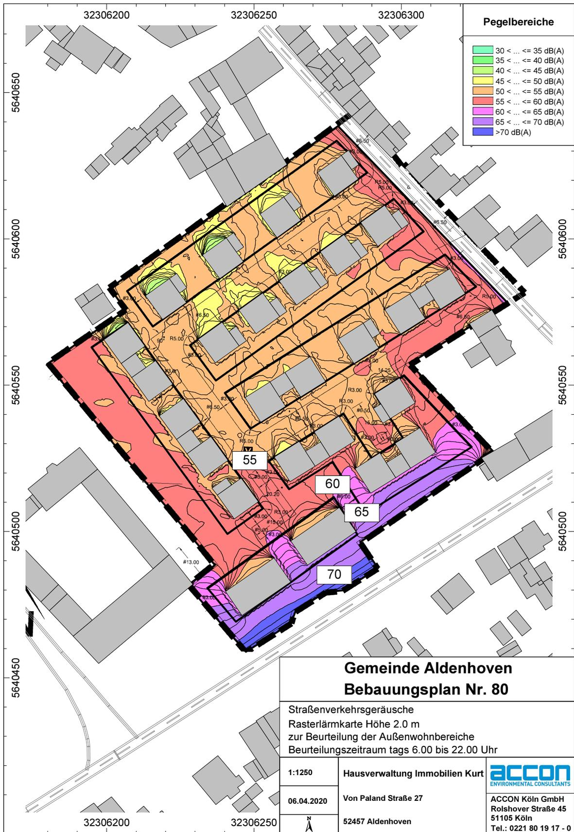
Abb. 4.2.7 Lärmkarte für h = 2 m über Gelände zur Beurteilung der Außenwohnbereiche
