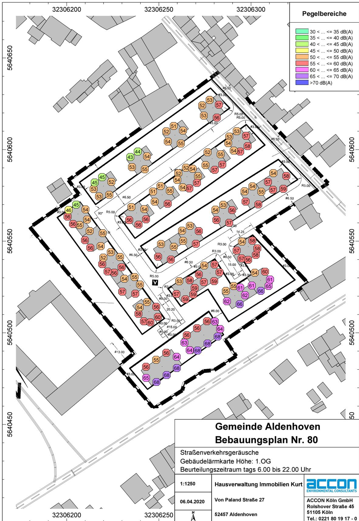
**Abb. 4.4.3** Darstellung der Verkehrsrgeräuschimmissionen tags für das 1.OG in Form einer Gebäudelärmkarte
