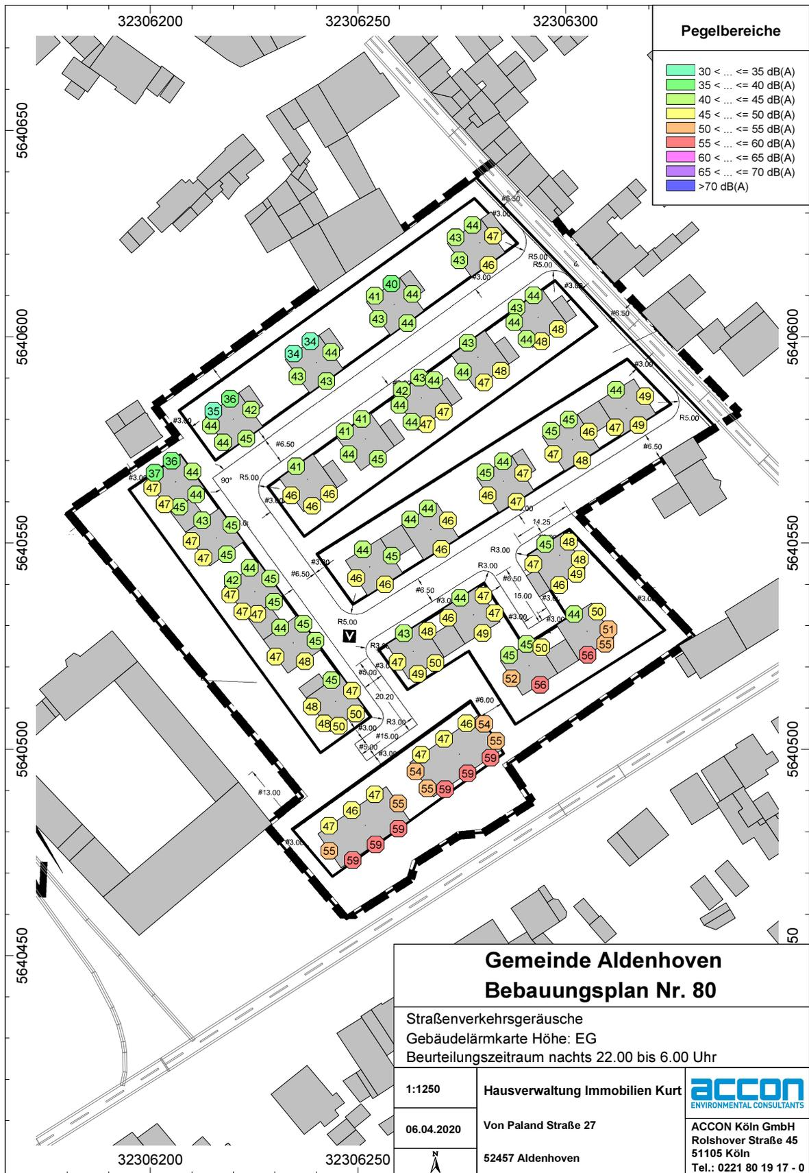
**Abb. 4.4.2** Darstellung der Verkehrsrgeräuschimmissionen nachts für das EG in Form einer Gebäudelärmkarte
