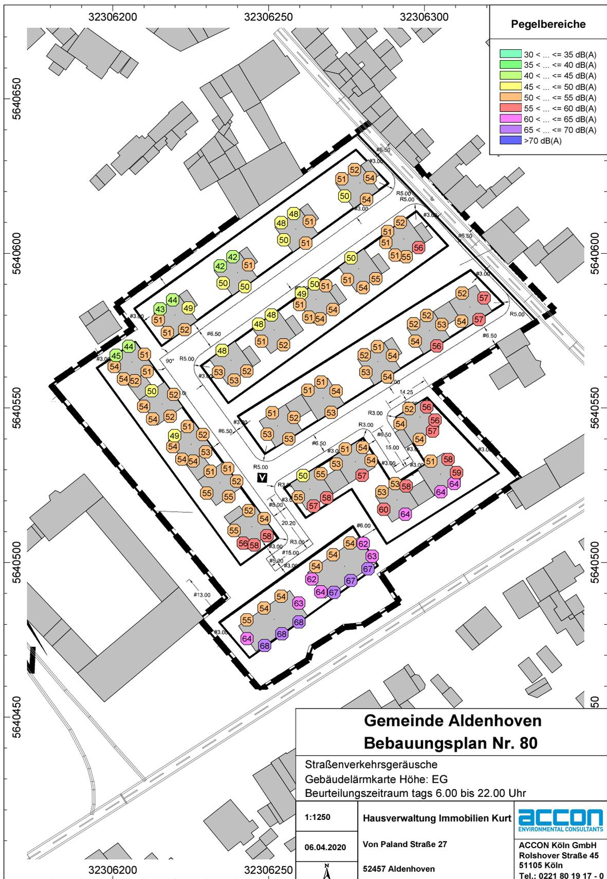
**Abb. 4.4.1** Darstellung der Verkehrsgeschwimmungen tags für das EG in Form einer Gebäudelärmkarte
