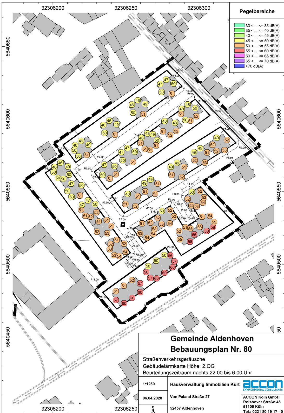
**Abb. 4.4.6** Darstellung der Verkehrsgeräuschimmissionen nachts für das 2.OG in Form einer Gebäudelärmkarte
