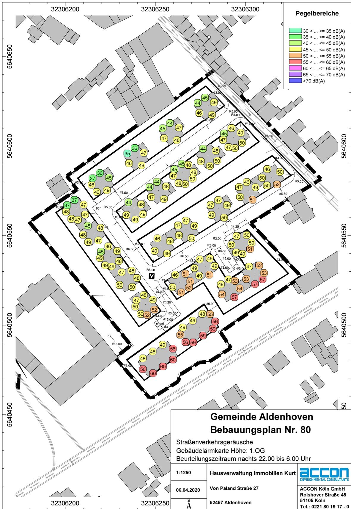
**Abb. 4.4.4** Darstellung der Verkehrsgeräuschimmissionen nachts für das 1.OG in Form einer Gebäudelärmkarte
