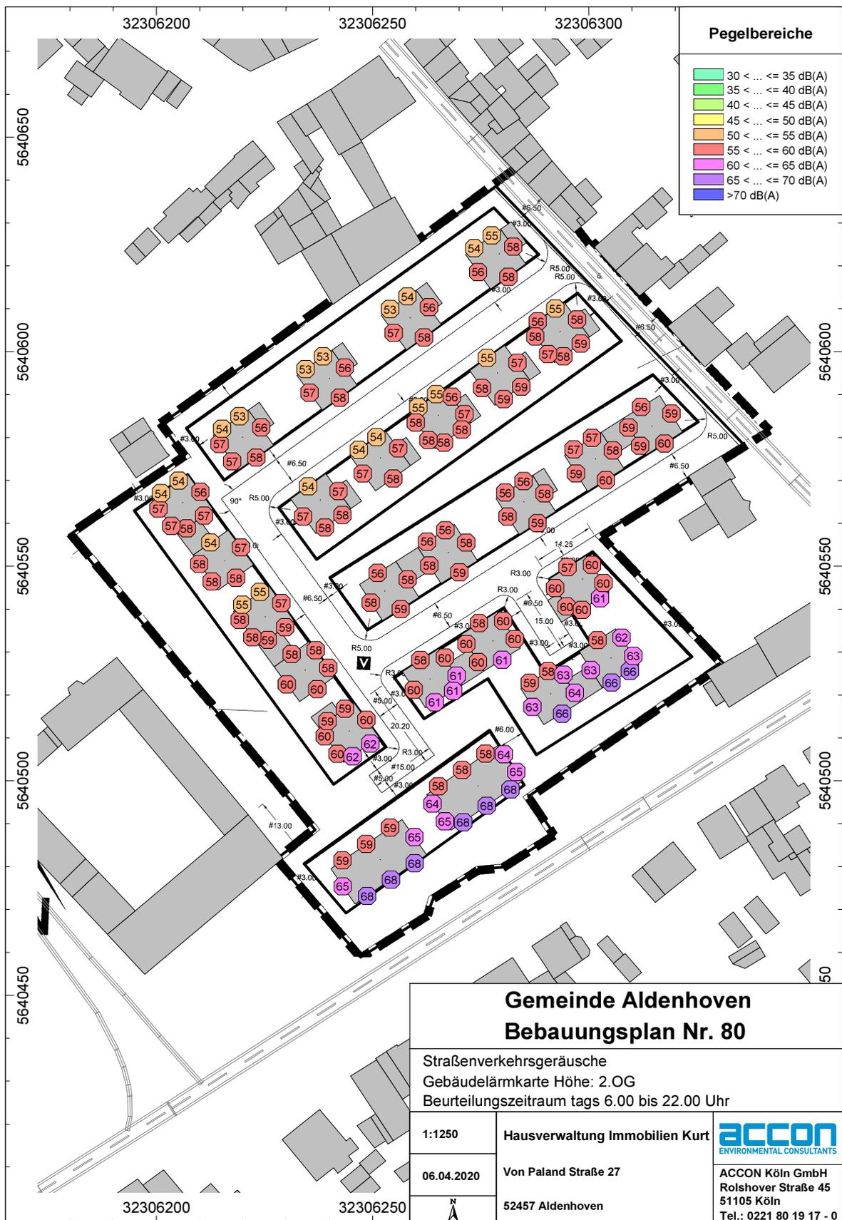
**Abb. 4.4.5** Darstellung der Verkehrsrgeräuschimmissionen tags für das 2.OG in Form einer Gebäudelärmkarte
