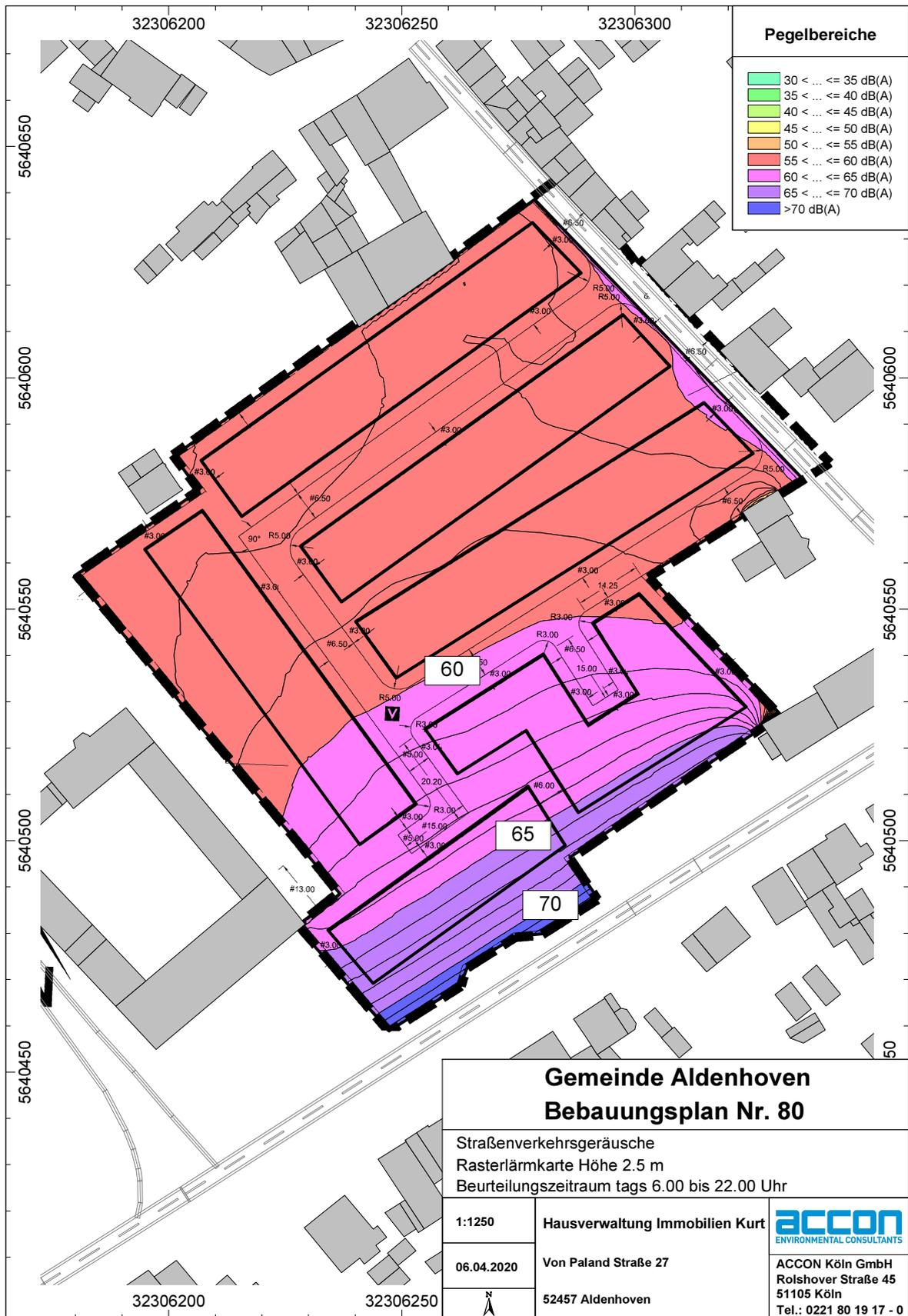
**Abb. 4.2.1** Darstellung der Geräuschimmissionen (Isophonendarstellung) in Höhe 2,5 m (EG) über Gelände, Betrachtung Verkehrsrgeräuschsituation
