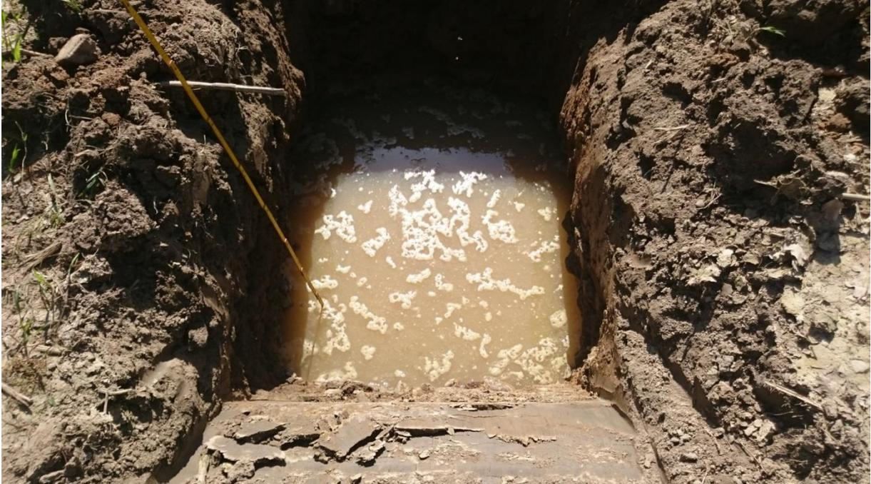
Abb. 4: Blick in Schurf 1 während des Sickerversuchs.
