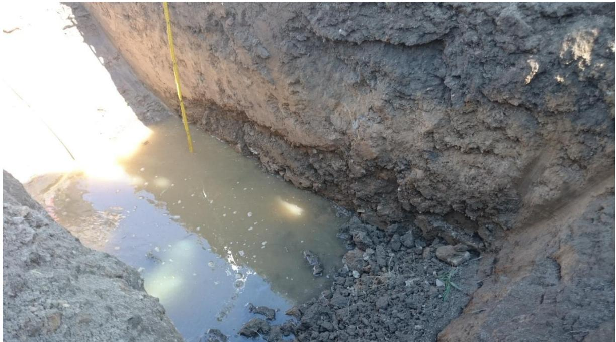
**Abb. 6:** Schurf 2 während des Sickerversuchs.
