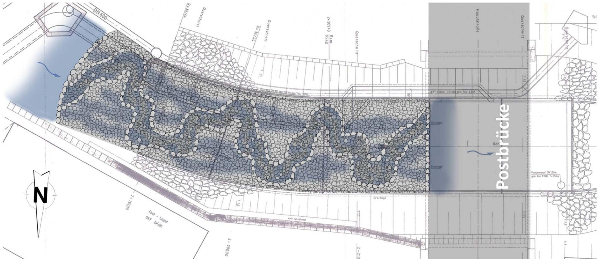
Ufermauern, gepflasterte Böschungen und Kanaltrassen begrenzen das Profil der Rühr am Beginn der Fußgängerzone. Zudem darf die Hochwasserabfuhr unter der Postbrücke nicht verschlechtert werden. Diese restriktiven Randbedingungen schränken den Planungsspielraum stark ein. Daher sieht das Konzept einen dem Baubestand angepassten Fischaufstieg vor.
