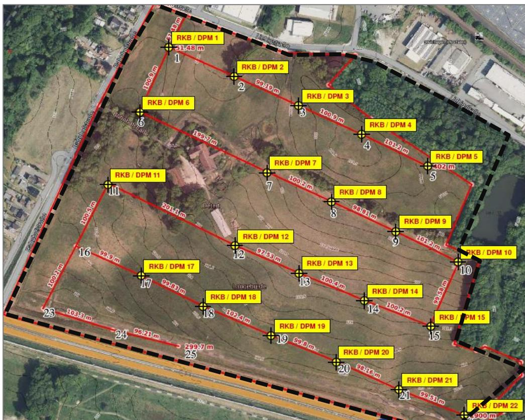
**Abb. 8** Lageplan der Kleinrammbohrungen (RKB) im Plangebiet
