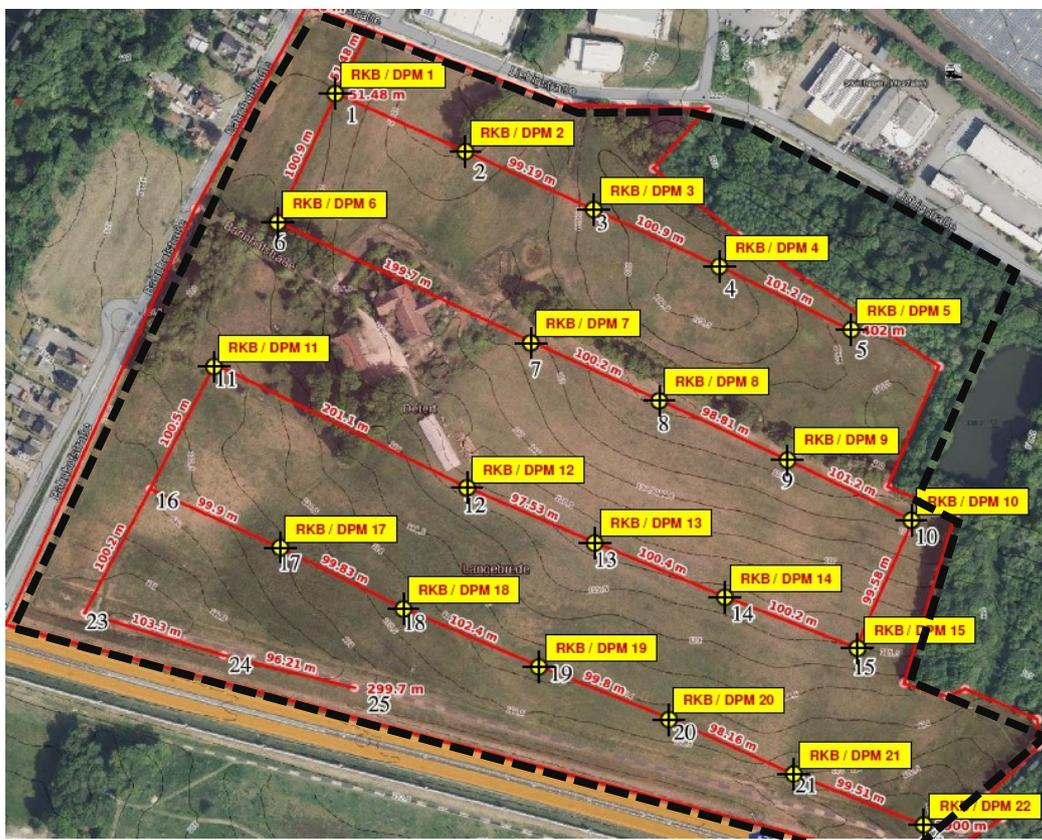
**Abb. 8** Lageplan der Kleinrammbohrungen (RKB) im Plangebiet, gelb Auffüllung Lehmgrube, Erdbaulabor Schemm GmbH 2022
