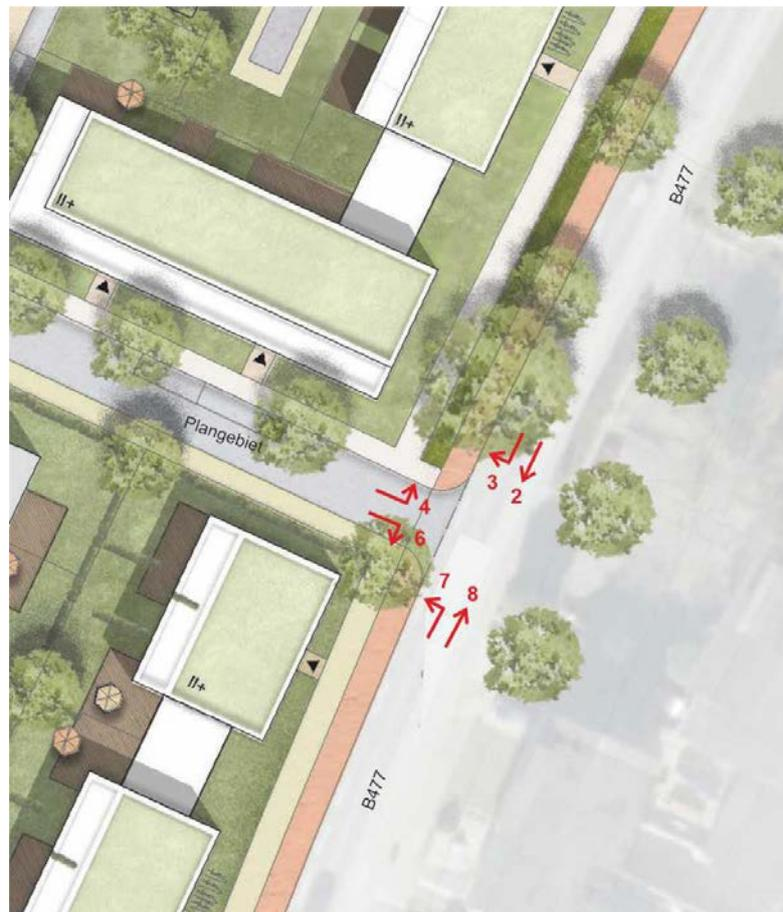
Bild 23: Zuordnung der Knotenströme<sup>9</sup>
