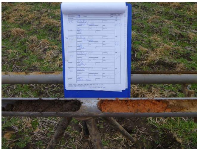
Abbildung 4: B5 mit verwittertem Ziegelbruch (hellrot) vermischter Sand
