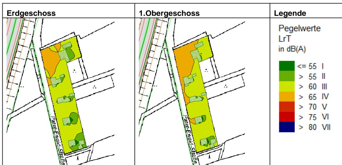
Abbildung 3 – Darstellung maßgebliche Außenlärmpegel und Lärmpegelbereiche gemäß DIN 4109
