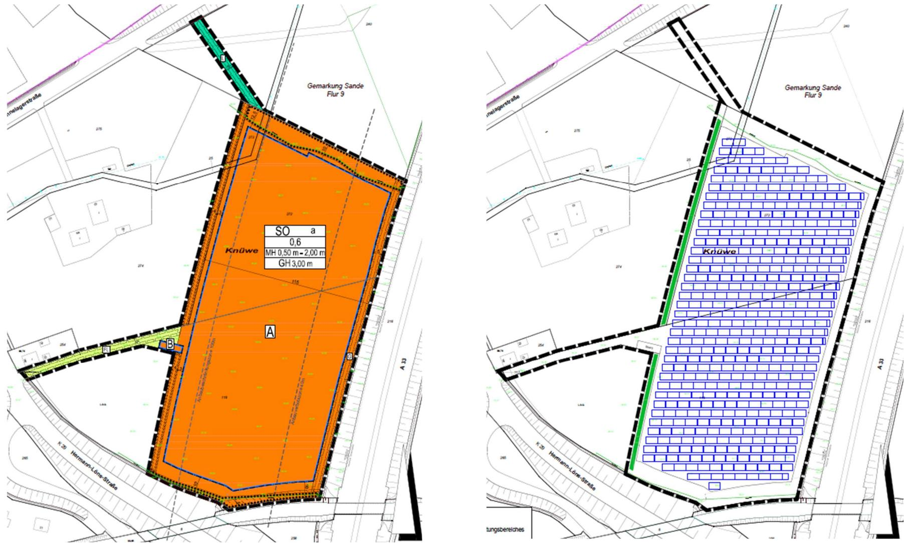
Abb. 2 Auszug aus dem vorhabenbezogenen Bebauungsplan S 345 „Photovoltaikanlage A 33 / Hermann-Löns-Straße“ und Anordnung der Solarzellen (rechts) (DHP 2021).
