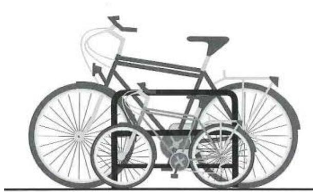
Abb. 21 Anlehnbügel mit Möglichkeit zum Anschließen von Kinderrädern<sup>14</sup>
