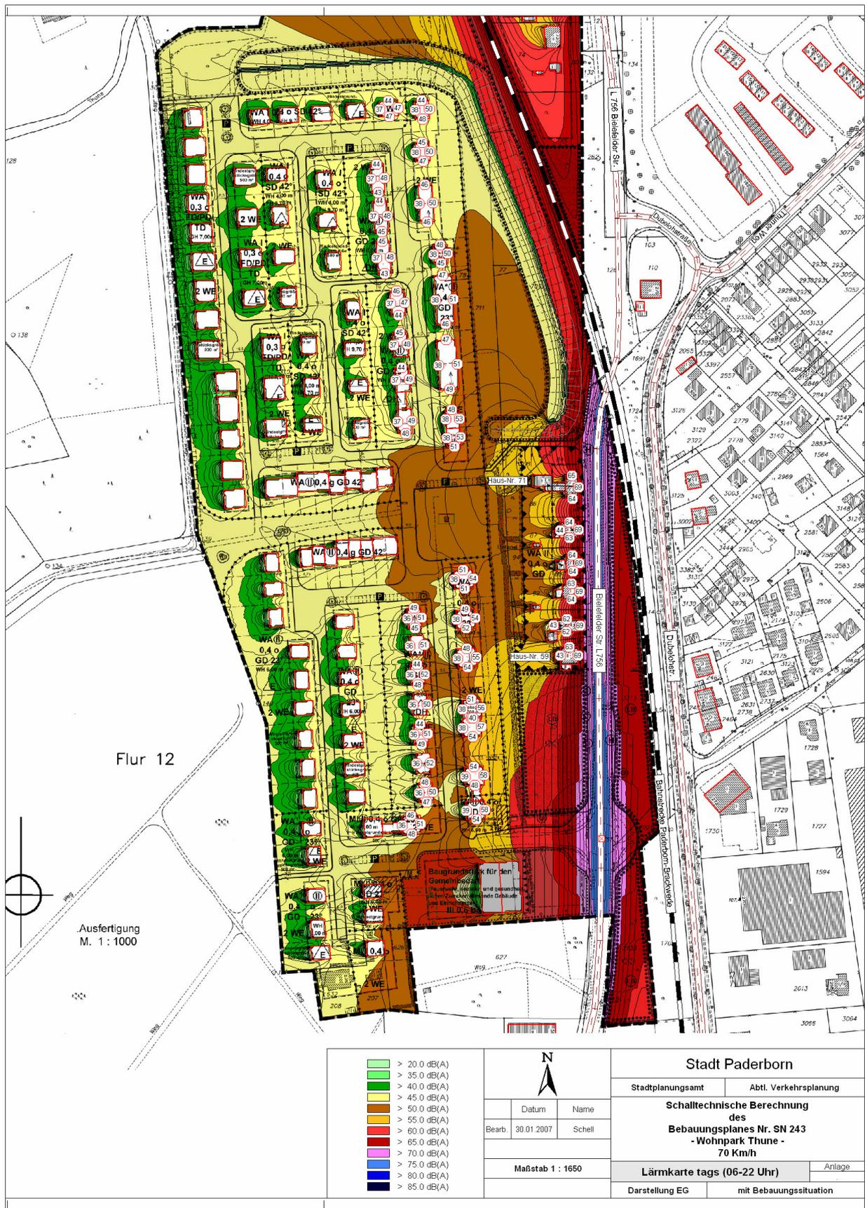
Lärmkarte Prognosezustand 2, mit Wall tags im EG bei 70 km/h und Bebauungssituation nach Gestaltungsplan
