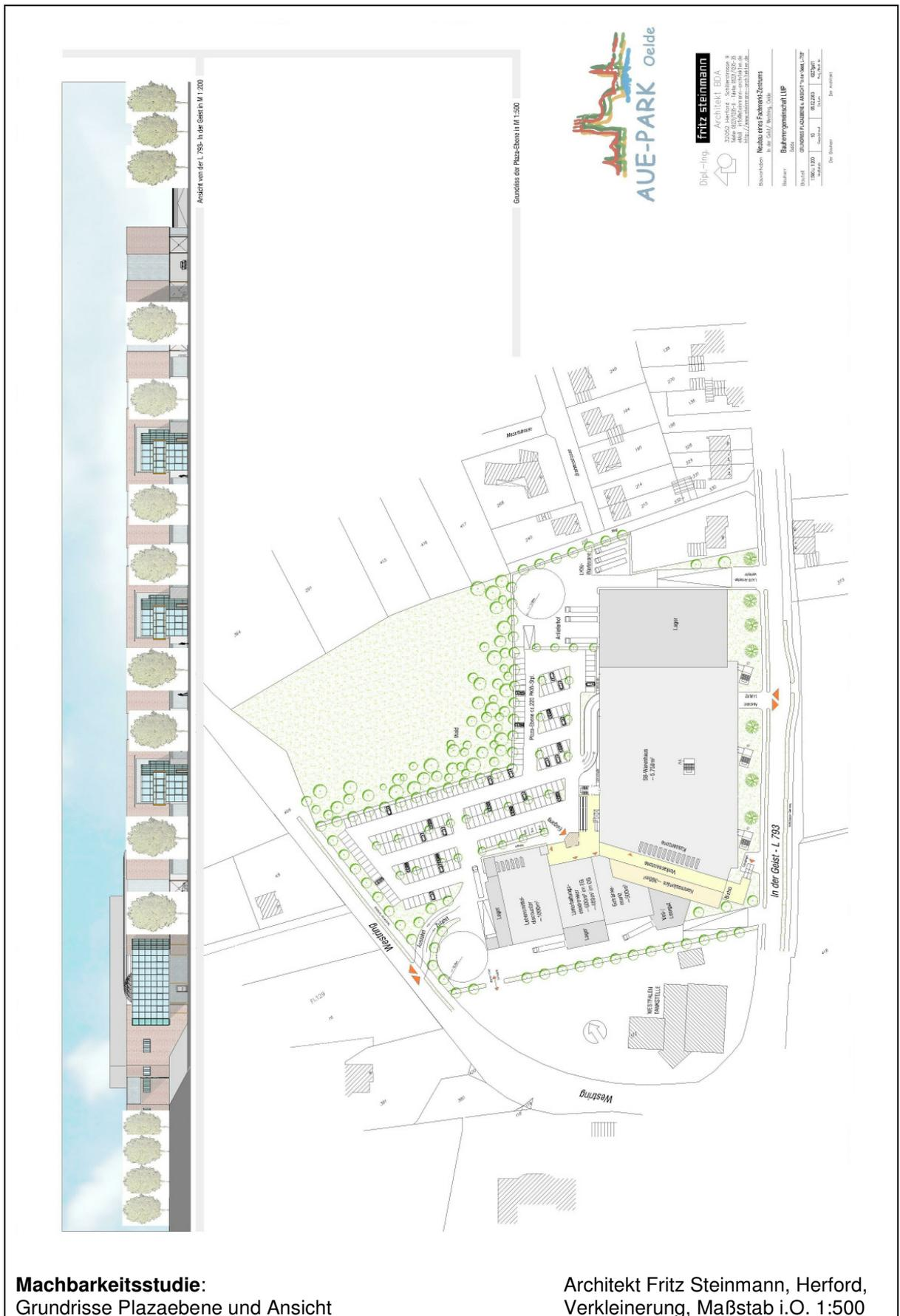
Die Andienungszone für den Verbrauchermarkt liegt im Norden und ist im Schallgutachten geprüft worden. Diese Zufahrt ist aufgrund der in der Prüfung favorisierten Zufahrt für Pkw in das Untergeschoss notwendig. Eine zweite Zufahrt über die Stellplatzanlage für Lkw dient im Süden parallel zur Grundstücksgrenze der Andienung des Getränkemarktes, des Discounters etc.
