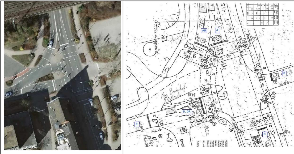
Abb.6: LSA L793 / Am Bahnhof: Luftbild und Signallageplan (aus verkehrstechnischen Unterlagen vom 15.09.2010)
