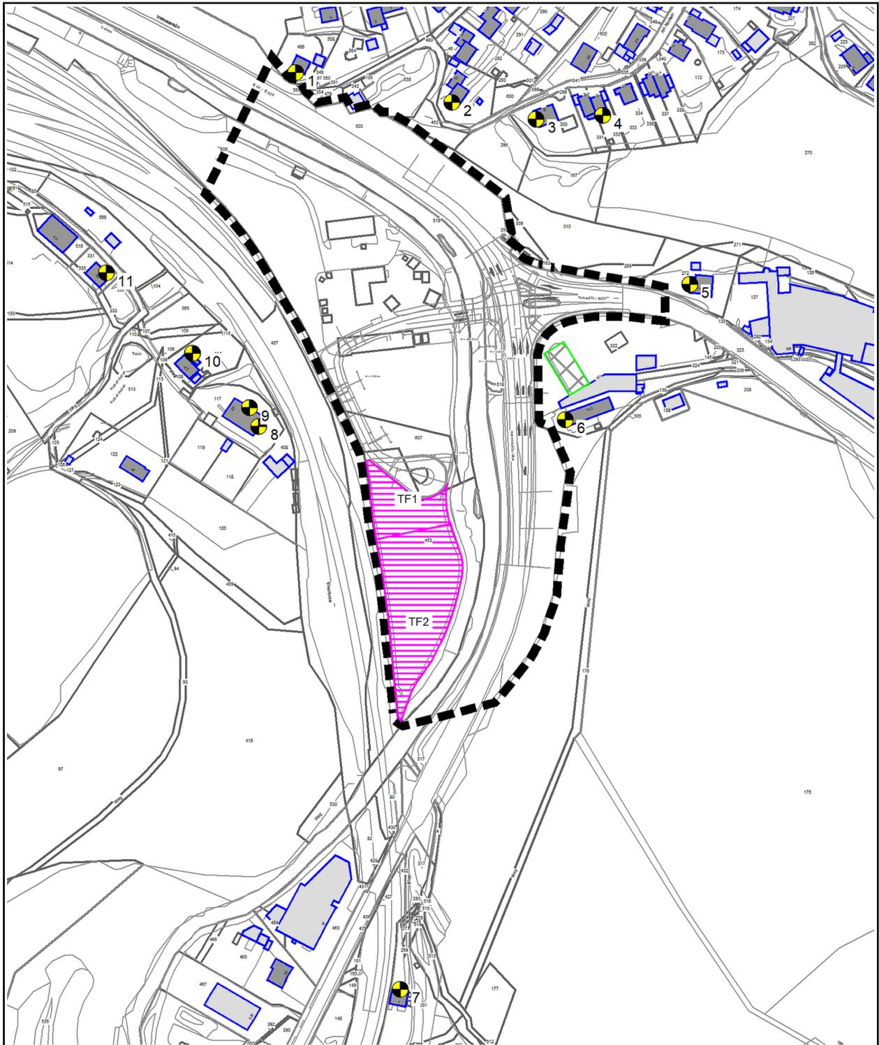
Abbildung 9: Darstellung des Berechnungsmodells für die Kontingentierung der Schallemission der gewerblichen Nutzungen nach DIN 45691
