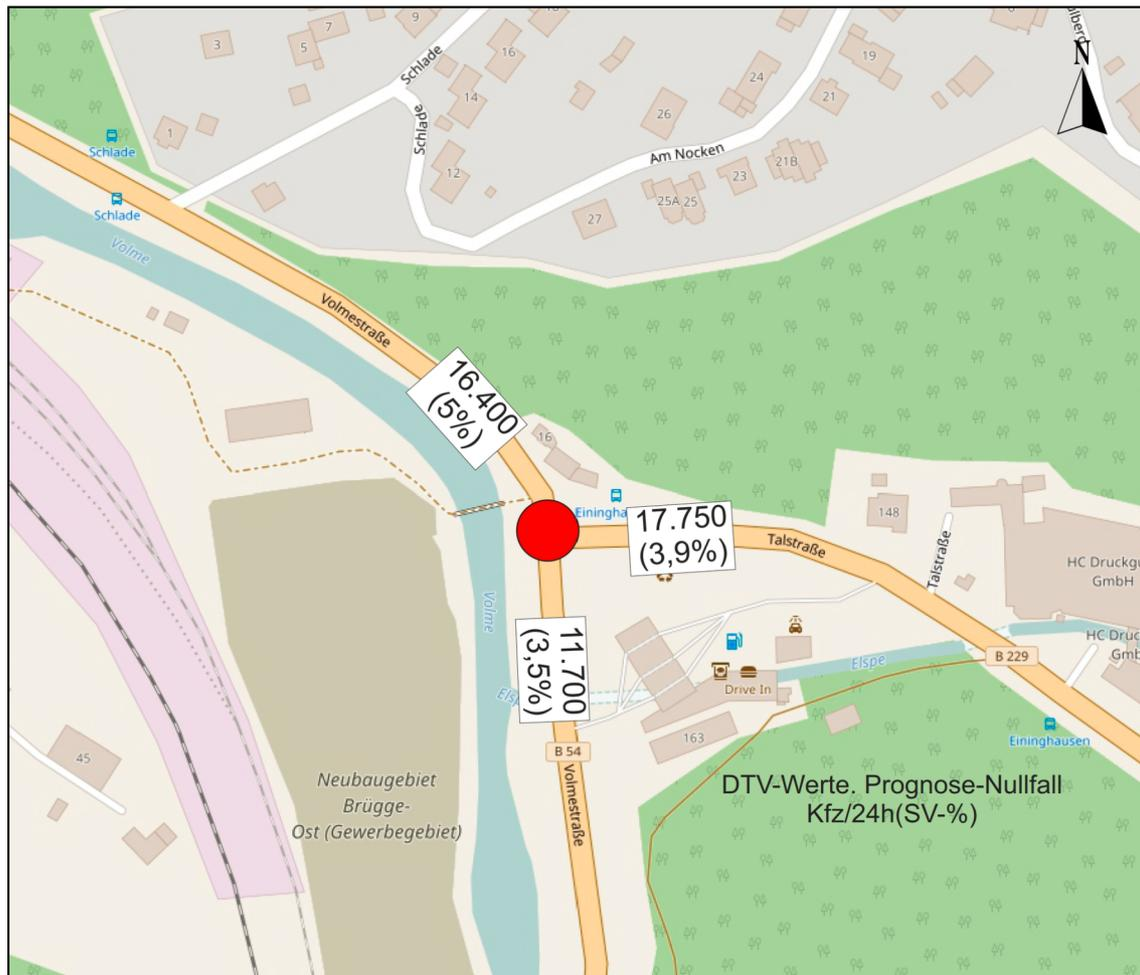
Abbildung 6: Darstellung der relevanten Verkehrsstärken im Prognose-Nullfall
