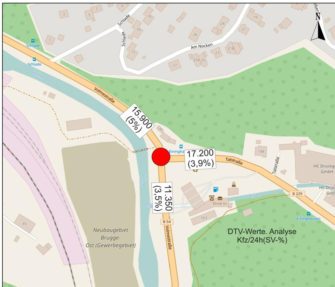
Abbildung 5: Darstellung der relevanten Verkehrsstärken im Analysefall
