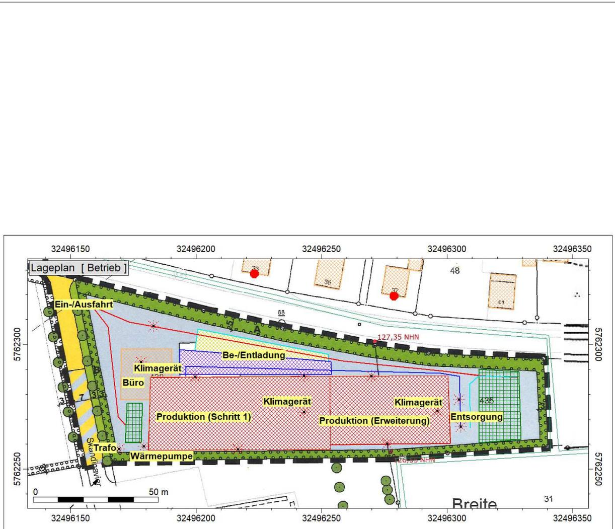
Planinhalt: Betrieb des geplanten Bürogebäudes mit Produktionshalle an der Voßheider Straße 36 in Lemgo zur Tages- und Nachtzeit mit Schallschutzmaßnahmen
