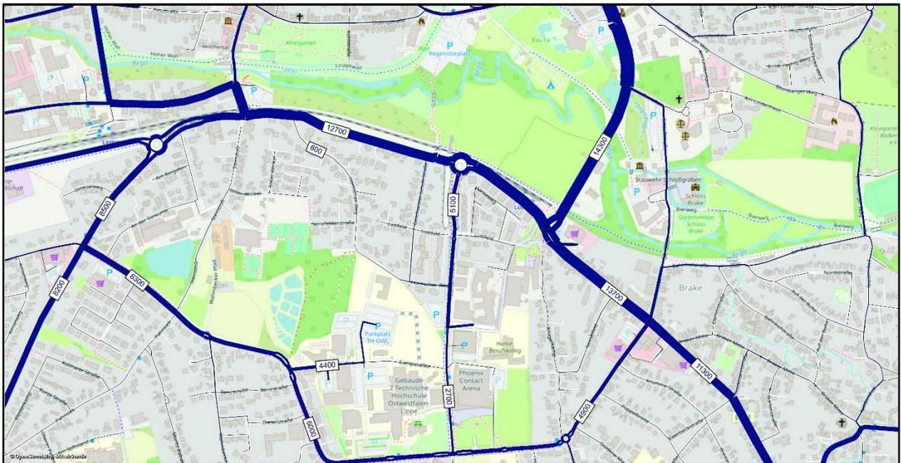
Abbildung 5: Auszug aus dem makroskopischen Verkehrsmodell mit den Verkehrsbelastungen (DTV) im Analysefall mit Abbindung der Campusallee in Kfz/24h
