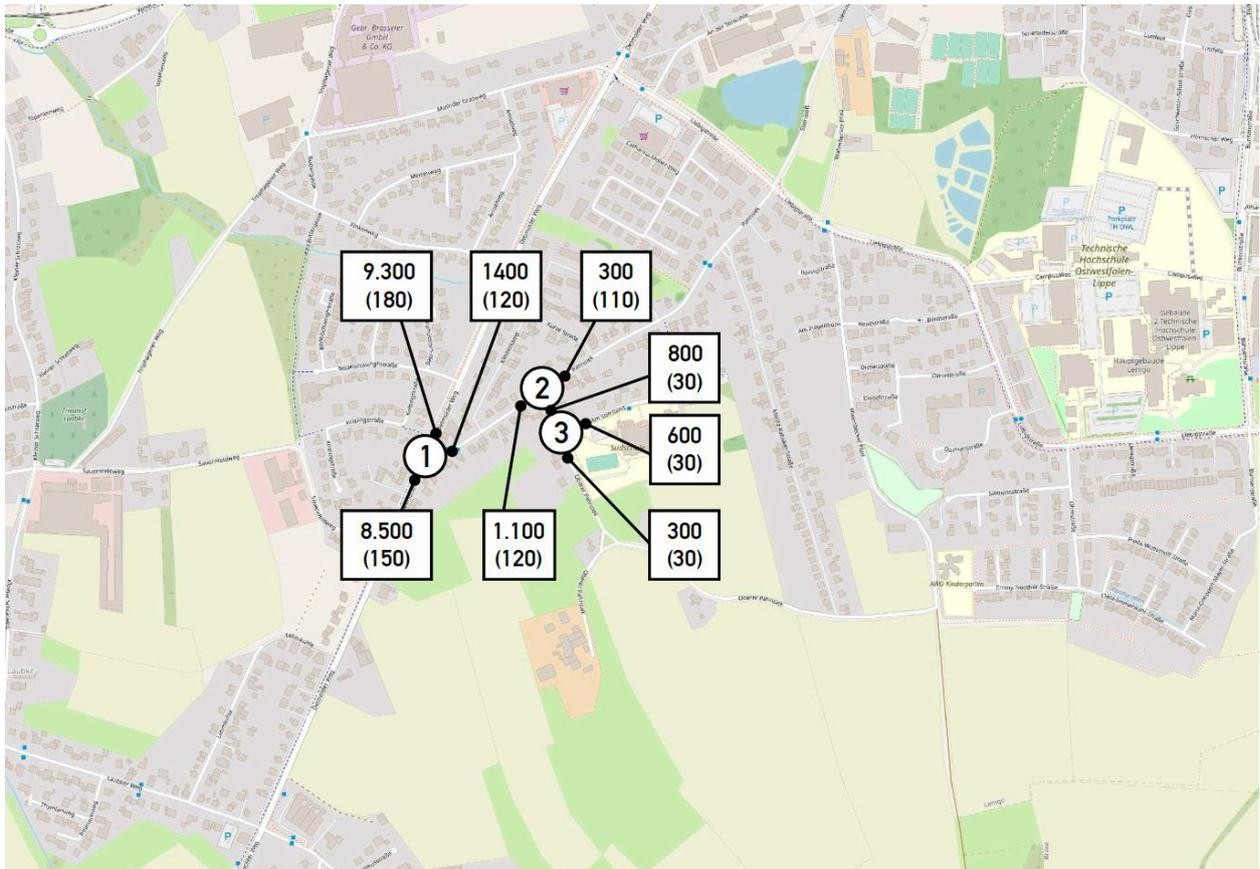
Abbildung 7: DTV im Analysefall in Kfz/24h
