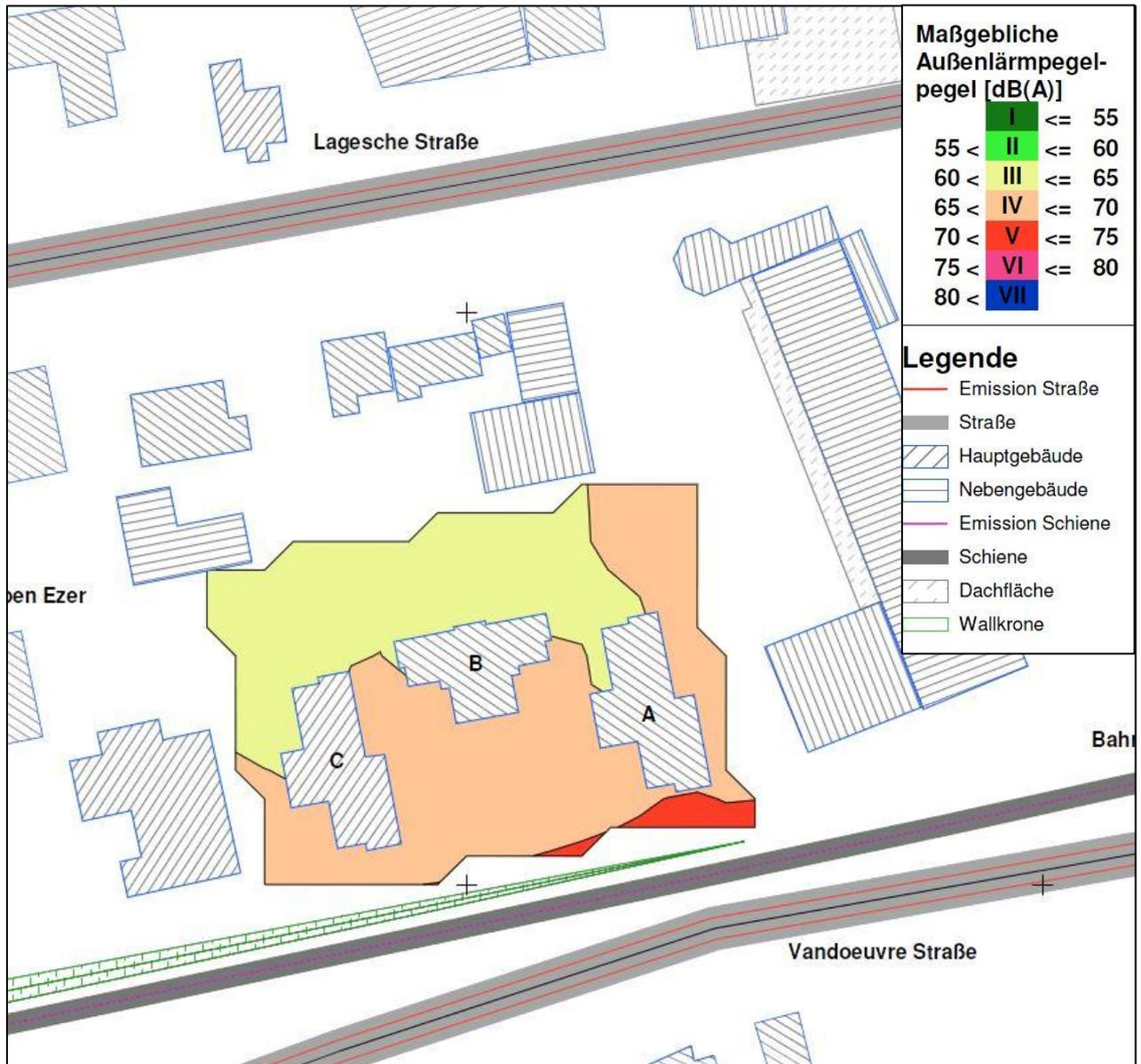
**Anlage 3: Lärmpegelbereiche nach DIN 4109; 2. Obergeschoss (8,0 m)**
