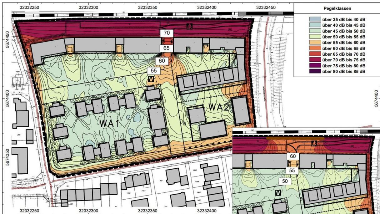
**Abb. 8:** Lärmkarte mit der Darstellung der Verkehrsgeräuschimmissionen in den Außenwohnbereichen tags in einer Höhe von 2 m über Gelände. Nebenkarte rechts unten: Auswirkungen einer 3 m hohen und 50 m langen Lärmschutzwand mit Lage unmittelbar nördlich der Gebäudelücke. Quelle: ACCON Köln GmbH 2021 (dort: Karten 4.2.7 und 4.7.2).
