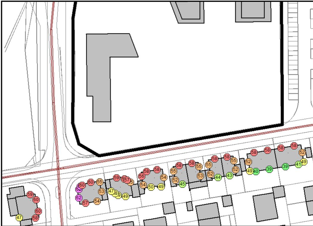
**Abb. 7.3** Maximale Beurteilungspegel tags (Straßenverkehr) für die Planungssituation
