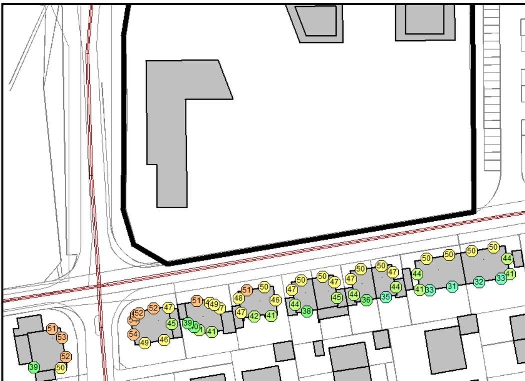
**Abb. 7.4** Maximale Beurteilungspegel nachts (Straßenverkehr) für die Planungssituation
