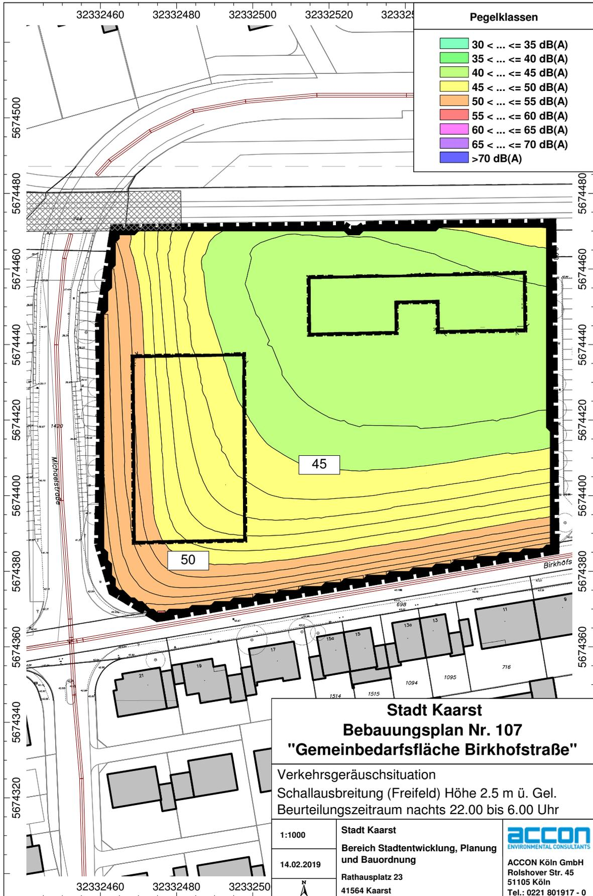
**Abb. 4.2.2** Darstellung der Geräuschimmissionen (Isophonendarstellung) in Höhe 2,5 m (EG) über Gelände, Straßenverkehrslärmsituation nachts
