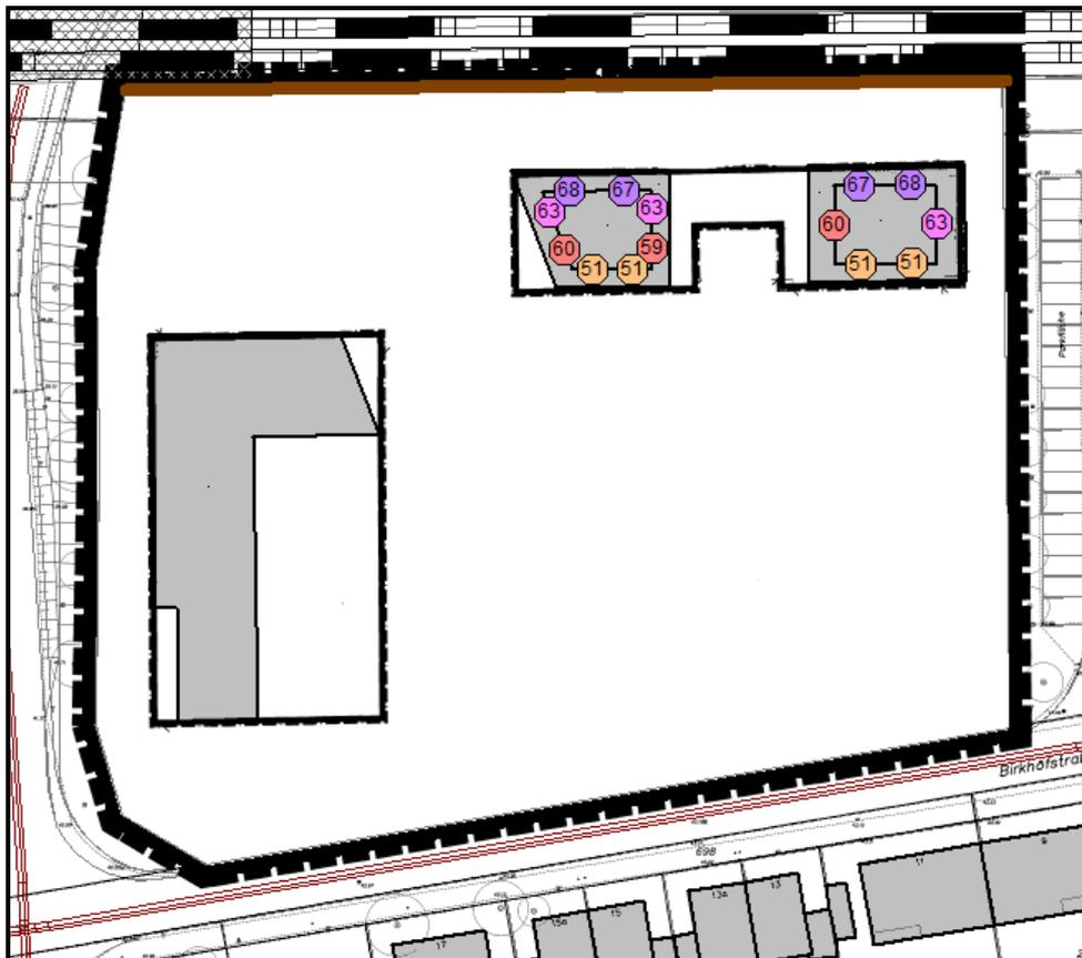
**Abb. 4.6.5** Gebäudelärmkarte Höhe 2.OG (Staffelgeschosse) tags (mit Lärmschutzwand, h = 2,5 m)
